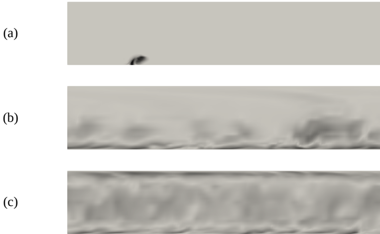
Рис. 18 — Амплитуда скорости при M = 6 , Re = 6000 , A = 1 , T = 1 : t = 1 (a), t = 41 (b), t = 81 (c), сечение в продольной плоскости канала через центр возмущения
