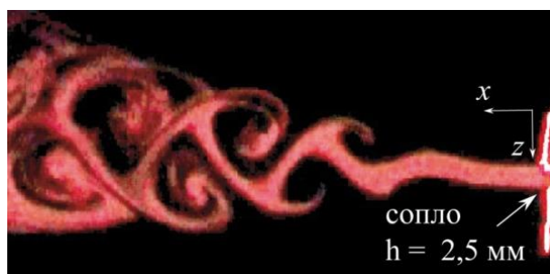
Рис. 7.4. Визуализация процесса развития плоской струи, истекающей из сопла шириной выходной щели 2,5 мм, под воздействием внешнего акустического поля ( f = 100 Гц).
