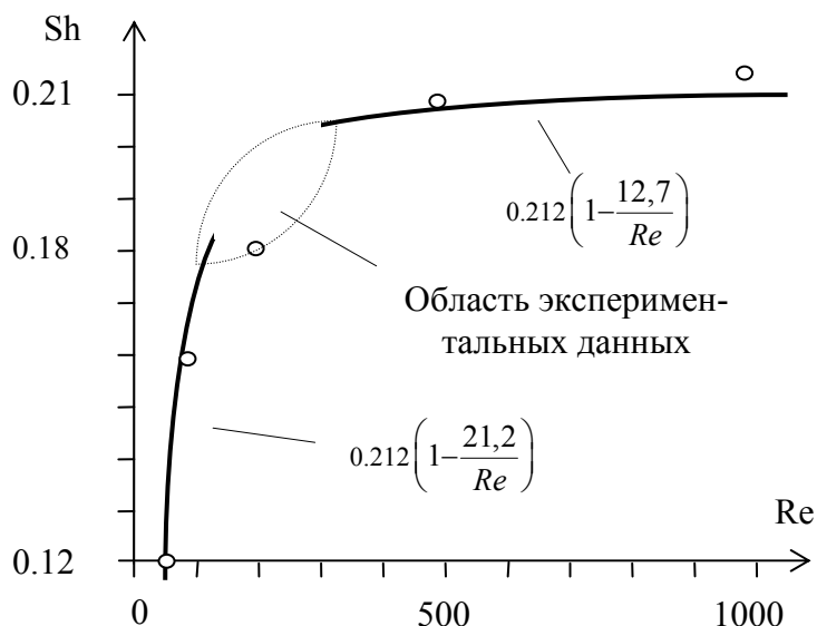
Рис. 4. Зависимость числа Струхалиа от числа Рейнольдса и сравнение с экспериментальными данными.
