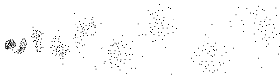
Рис. 3. Вихревая дорожка Кармана при t = 70 и Re = 1000 .
